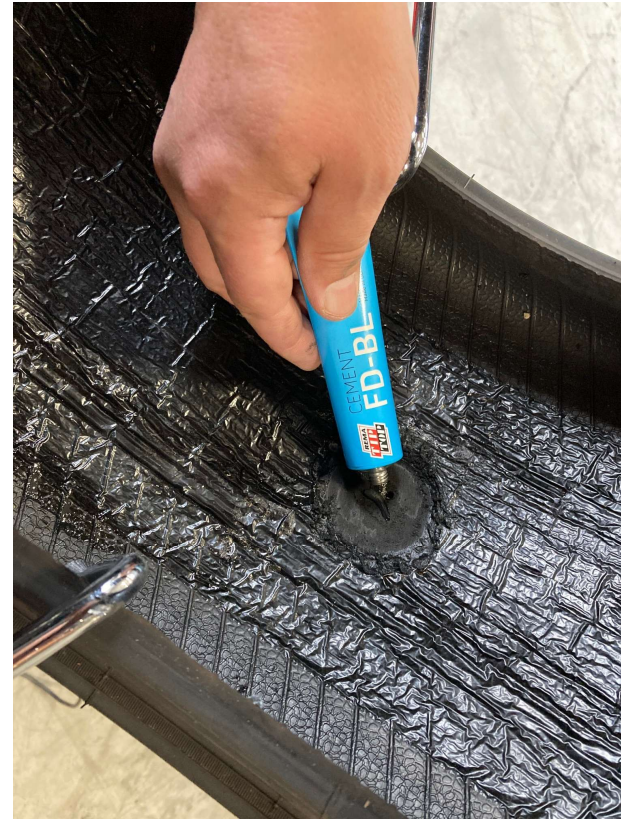
Kom et par dråber FD cement igennem skadeskanalen.
